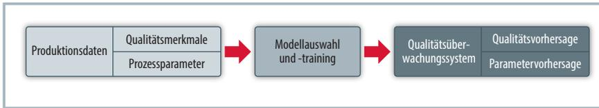
Bild 1. Ablauf der Vorbereitung der Qualitätsüberwachung. Quelle: IPH Hannover gGmbH © Hanser
